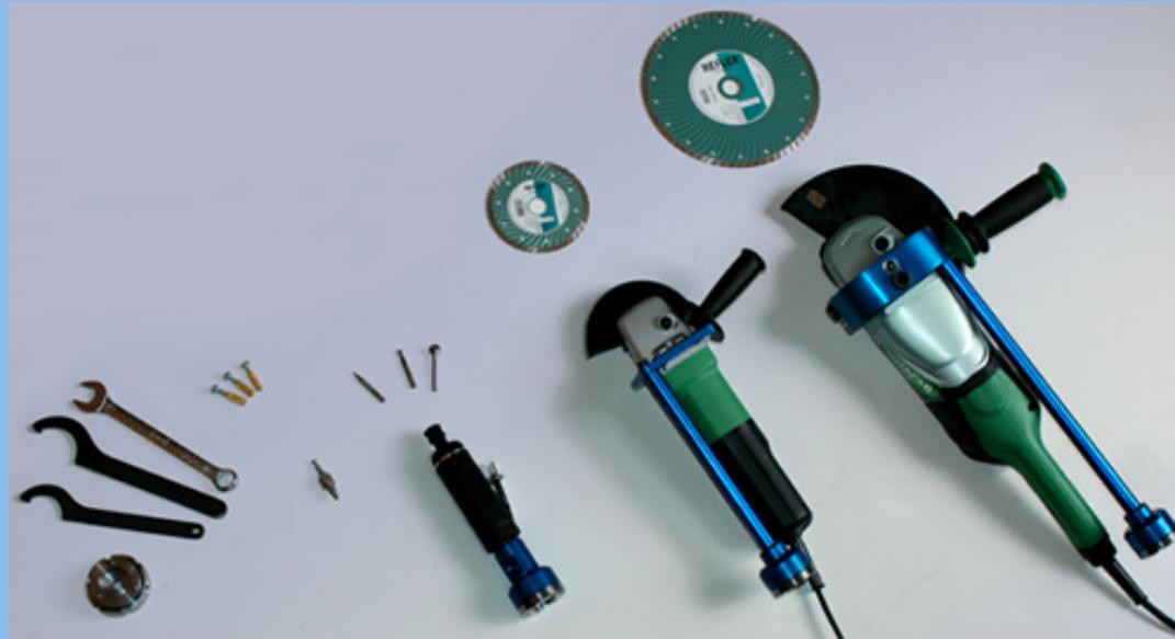
*Outillage complet paramétré dans le logiciel : disqueuses 125 et 230 mm, fraises 3, 6 et 12 mm*
